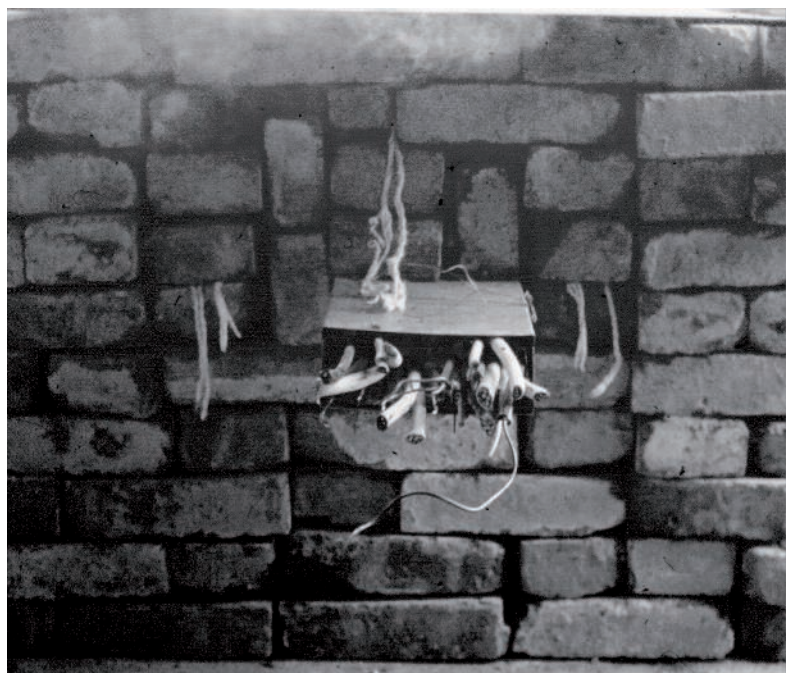
Estructura de prueba del primer aislamiento de cables de OBO
