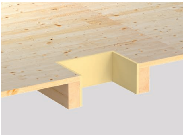
Techo de vigas de madera sin forjado o subtecho
