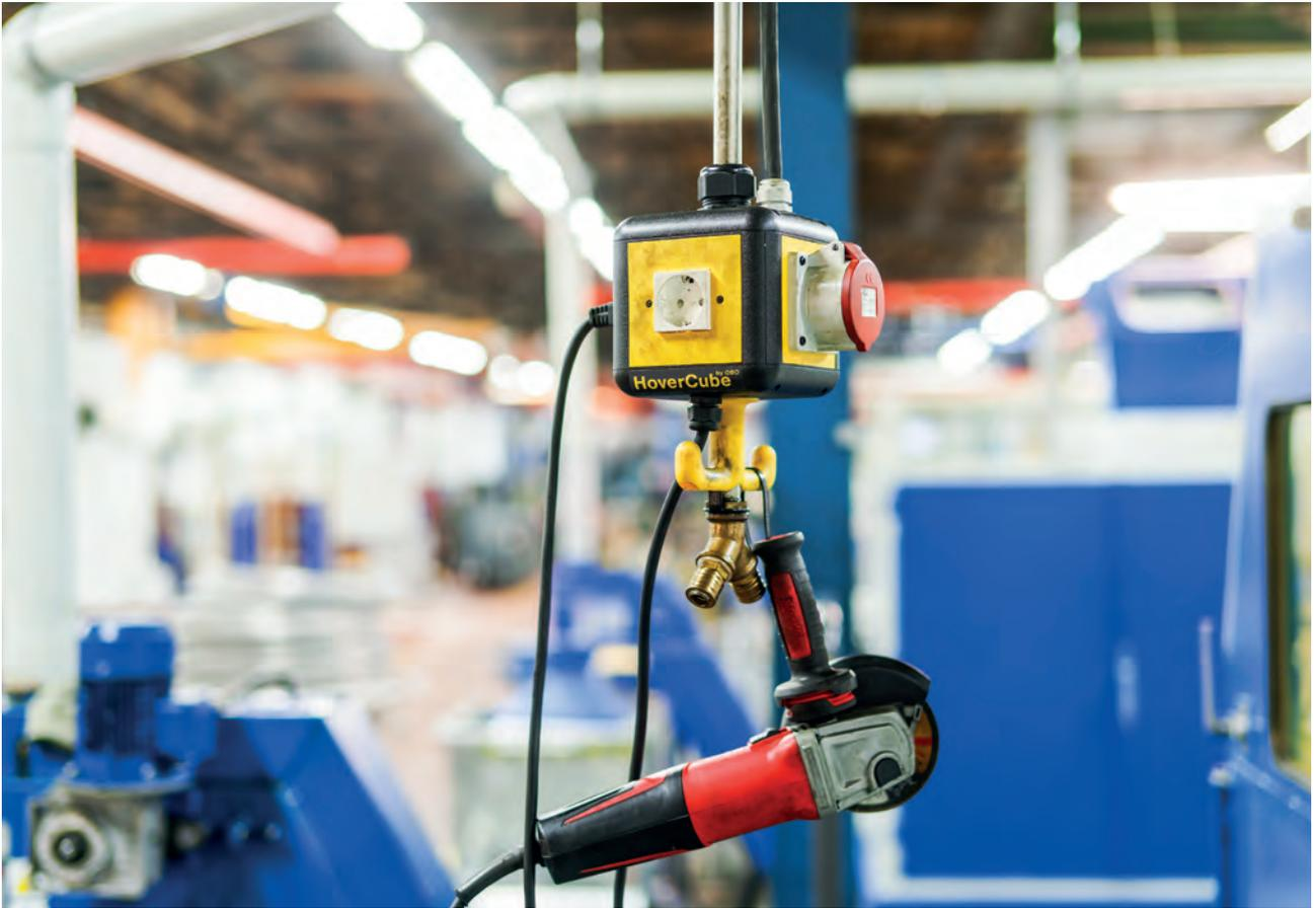
Hängender Energieverteiler für Arbeitsplätze und Maschinen in der Industrie, in Handwerksbetrieben und in Ausbildungsbereichen. Die HoverCubes sind frei im Raum positionierbar. Die Versorgung kommt aus der Decke. Sie können flexibel bestückt werden von Energie-, Daten- und Medientechnik bis hin zu Arbeitsmedien wie Druckluft.
