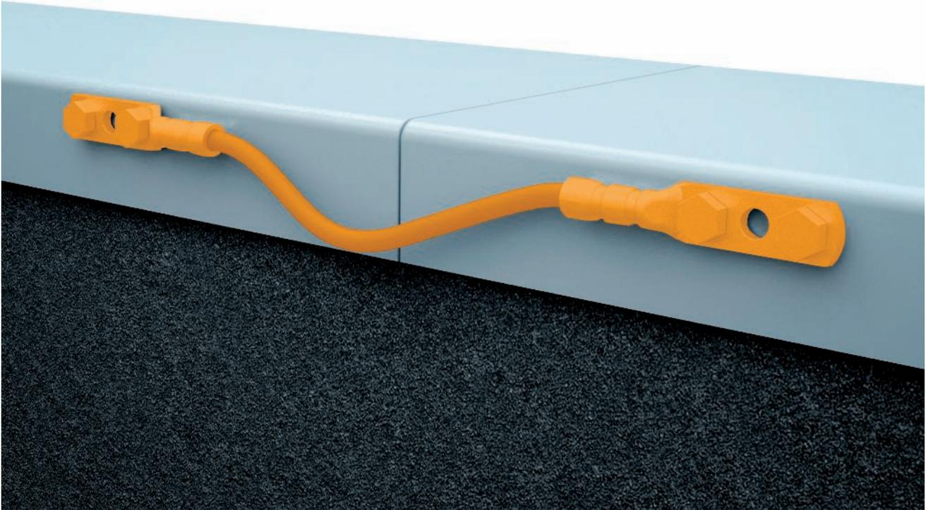
Mögliche Ausführung der Verbindung der metallenen Attika-Abdeckung durch Überbrückung mit flexibler Leitung
