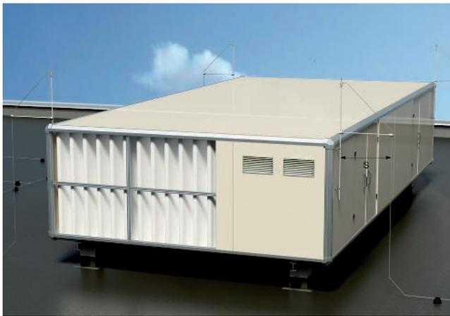
Isolierte Fangeinrichtung mit Trennungsabstand (s)
