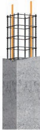
Beispiel: Nutzung von bewehrten Betonstützen/Ableitungseinrichtung
