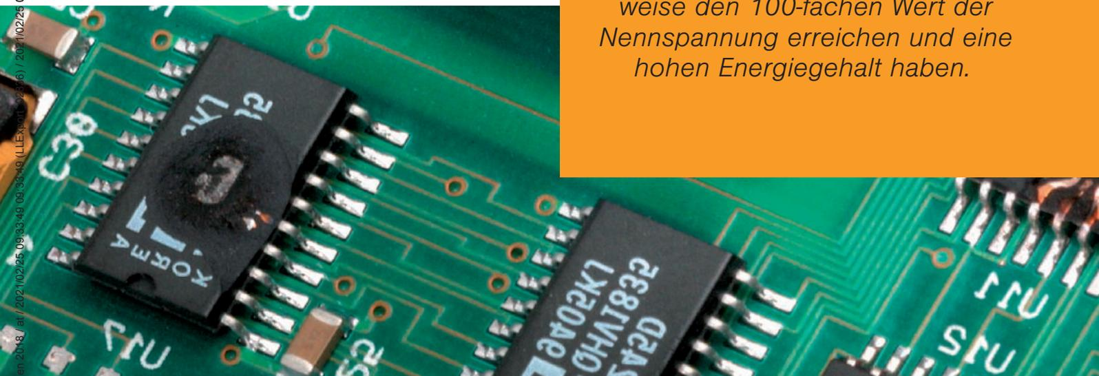
Durch Überspannung zerstörte Platine
