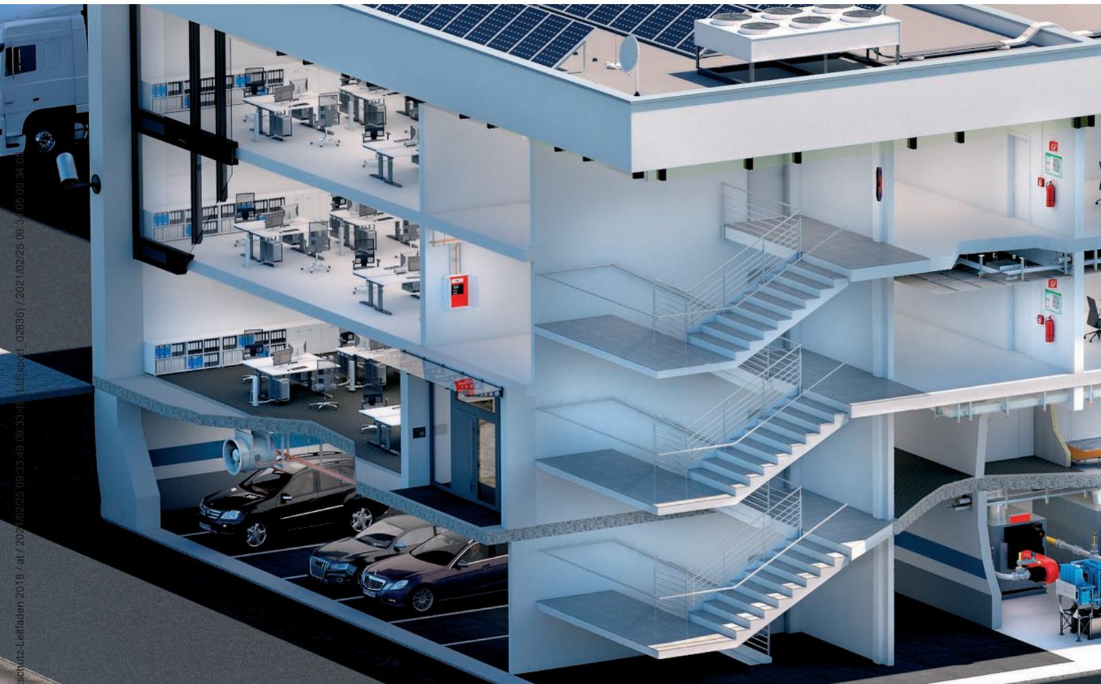
Bildung von Brandabschnitten durch Brandwände bzw. feuerverwehrende Bauteile
