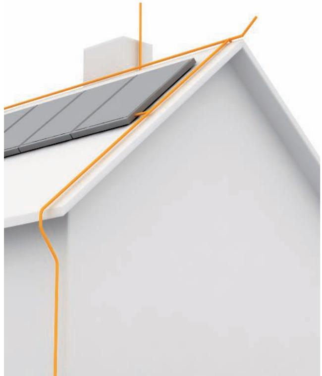
Direkter Anschluss der PV-Montagegestelle an die Blitzschutzableitung
