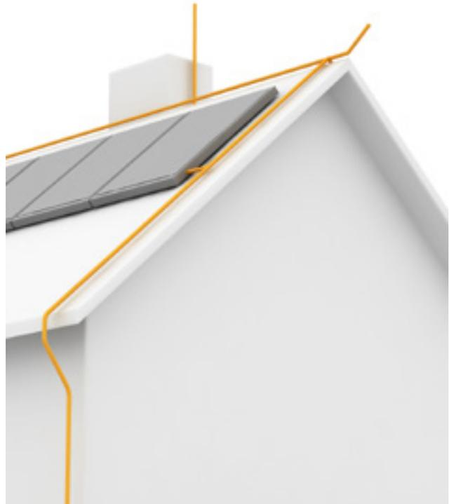
Direkter Anschluss der PV-Montagegestelle an das Blitzschutzsystem
