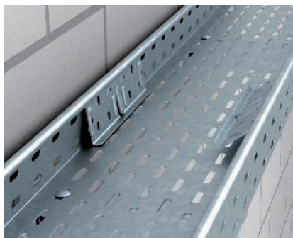
Montage Längsverbinder-Set RV Längsverbinding der Kabelrinnen durch einfaches Einklemmen des Verbinder-Sets RV in den Seitenholm.
