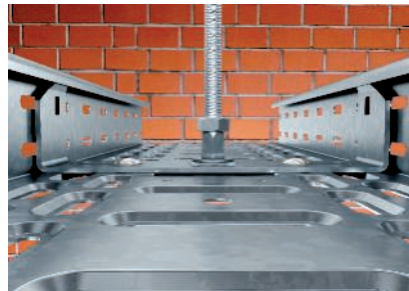
Sicherung der Gewindestange an der Mittenabhängung mit zusätzlicher Sechskantmutter.
