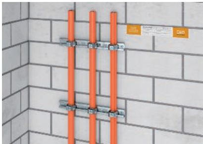
Senkrechte Montage der Kabel an der Wand mit Bügelschellen.
