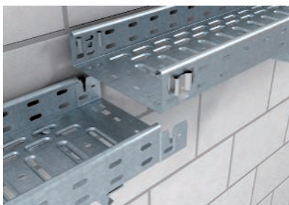
Erstellen der Längsverbinding durch Ineinanderstecken der Kabelrinnen.
