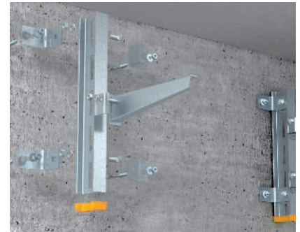
Wandbefestigung I-Stiel Montage eines I-Stiels an der Wand mit Befestigungswinkeln Typ BW 80/55 und Bolzenankern zur Aufnahme mehrerer Stielausleger Typ AS.
