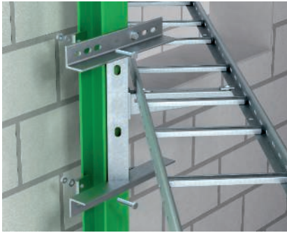
Adapterplatte 45°, Stahlklemmung Montage der Adapterplatte 45° Typ KA-E 45 an Stahlträger mit Klemmwinkeln oder Spannpratzen. Zur zusätzlichen Unterstützung bei Trassenverläufen an Winkeln und Raumecken.
