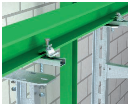
Anwendung am Stahlträger Klemmbefestigung von Hängestielen an Stahlträgern mit verschiedenen Spannklauen, längs oder quer zum Stahlträger.
