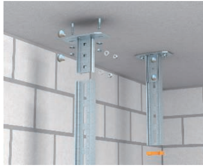
Kopfplattenmontage Befestigung der Standard-Kopfplatte KI 8 für I-Hängestiele an Betondecke mit Bolzenankern.
