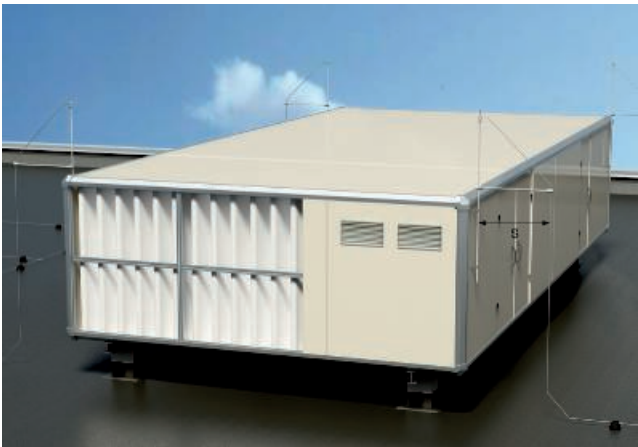
Geïsoleerde opvanginrichting met scheidingsafstand (s)
