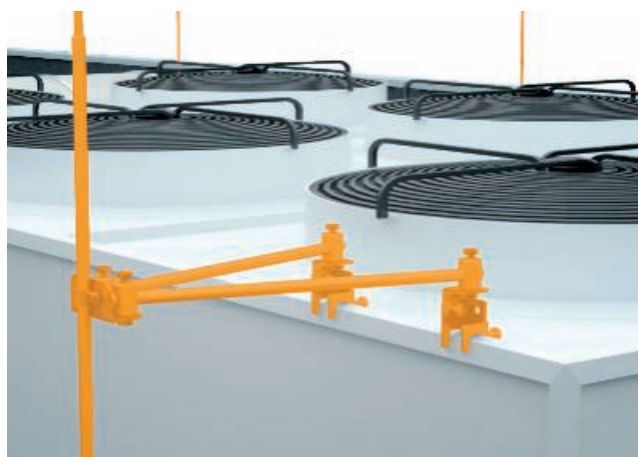
Voorbeeld: opvangsysteem met Iso-Combi-set voor randbevestiging
