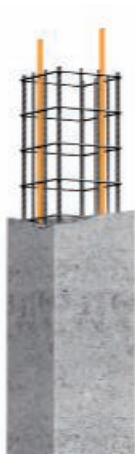
Voorbeeld: gebruik van gewapend betonkolommen/afleidingsinrichting
