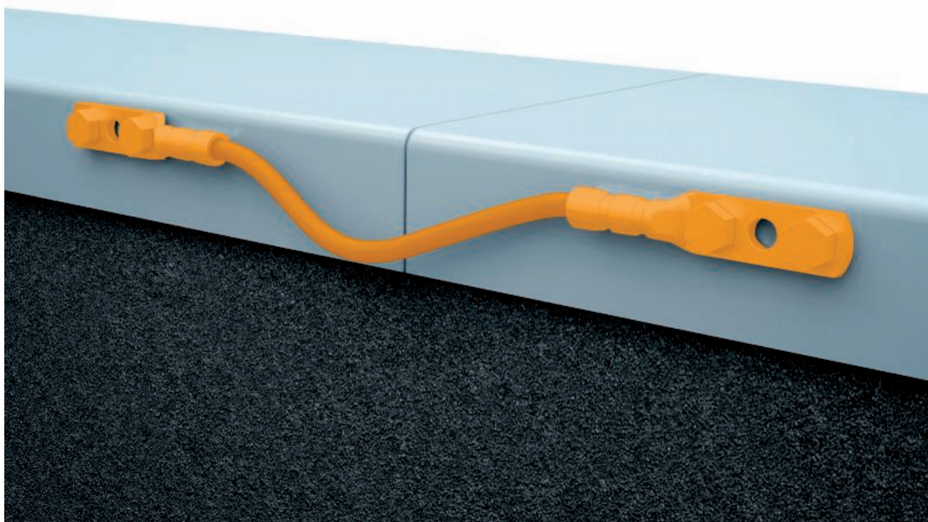
Mogelijke uitvoering van de verbinding van de metalen dakrand door overbrugging met flexibele leiding
