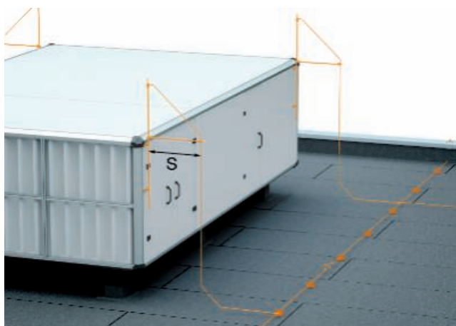
Voorbeeld: opvangsysteem met Iso-Combi-set voor driehoeksbevestiging
