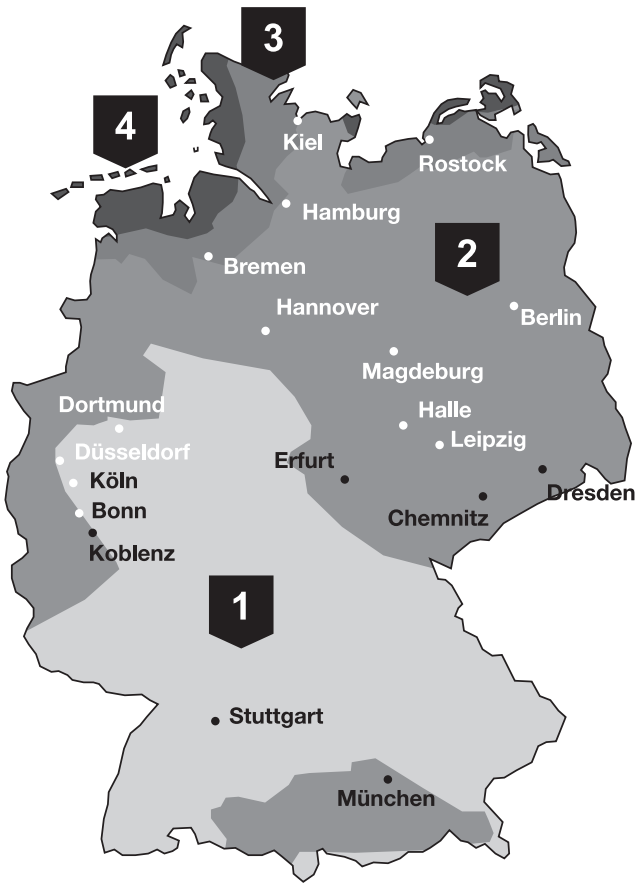
Windbelastingszones in Duitsland conform NEN-EN 1991-1-4 NA (landspecifieke informatie)
