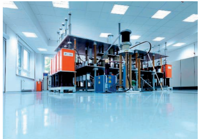
Bild 3: BET-Testgenerator
