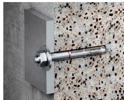
Bolzenanker Typ BZ Bolzenanker Typ BZ, zur Befestigung von Schwerlastverankerungen in gerissenem oder ungerissenem Normalbeton C20/25 bis C50/60, für Durchsteckmontage geeignet, mit Anschlussgewinde M8, M10, M12 oder M16.
