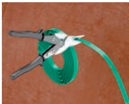
Spannband zuschneiden Das Spannband auf die benötigte Länge zuschneiden (z.B. mittels Blehschere).
