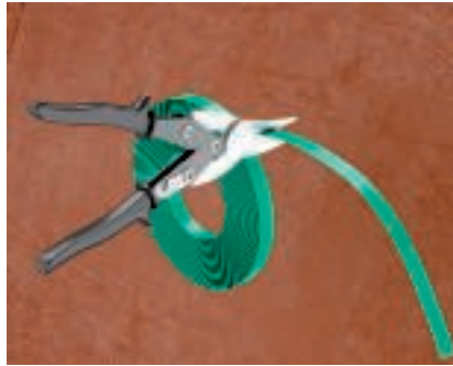
Spannband zuschneiden Das Spannband auf die benötigte Länge zuschneiden (z.B. mittels Blechschere).
