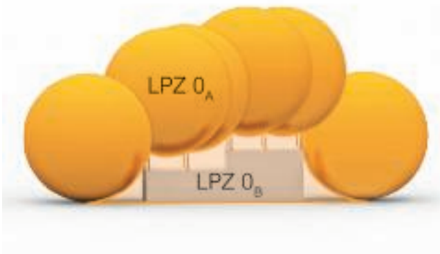
Blitzkugelverfahren und resultierende Blitzschutzzonen (LPZ)
