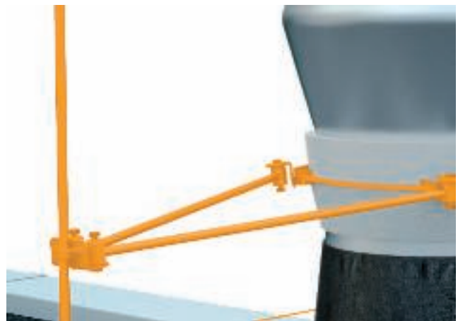
Beispiel: Fangsystem mit Iso-Combi-Set für Rohr-V-Befestigung
