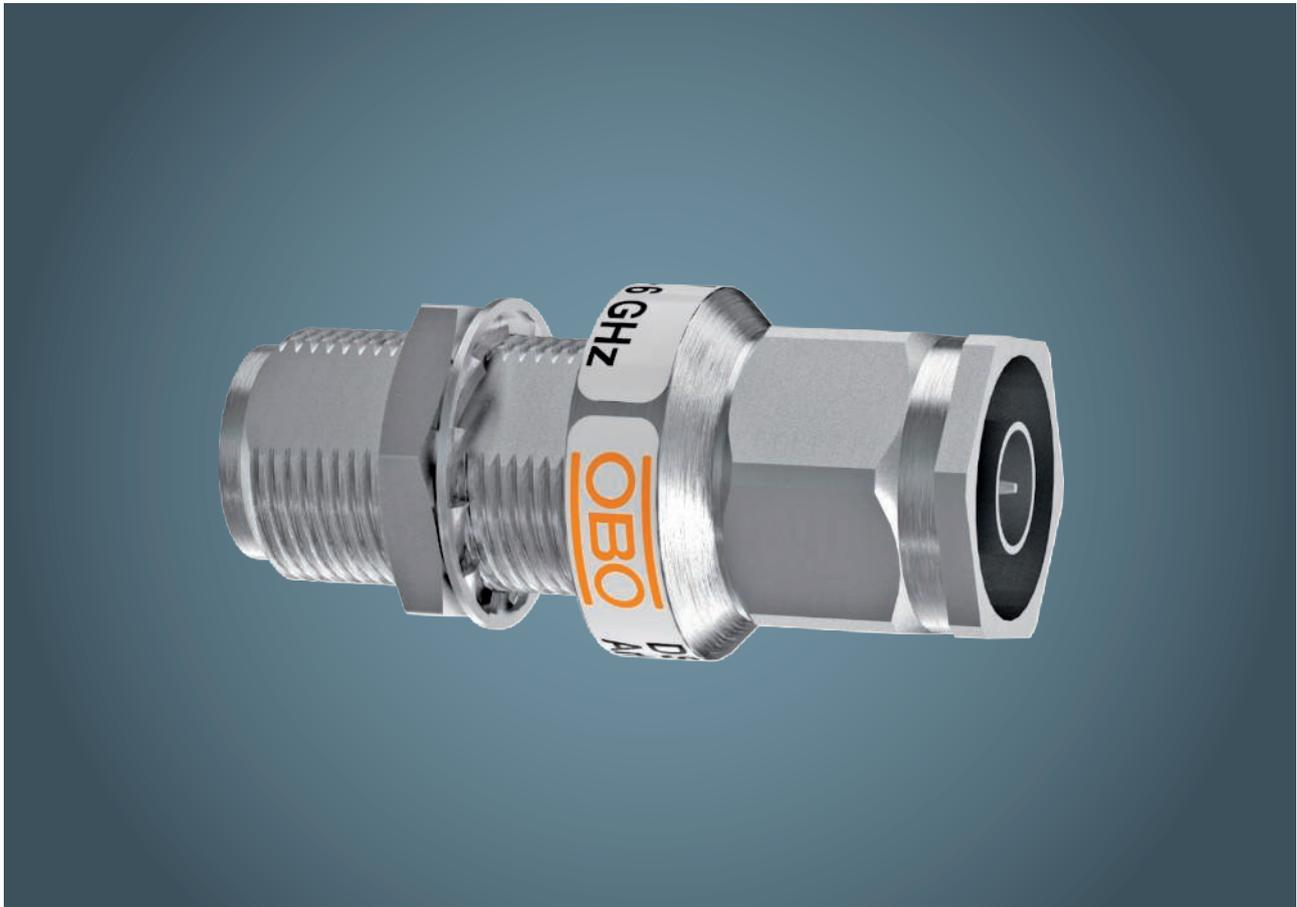
Die koaxialen Schutzgeräte vom Typ DS bieten optimalen Schutz empfindlicher Anlagen, basierend auf koaxialen Steckverbindungen. Die geringen Einfügedämpfungen und Rückflusdämpfungen bei unterschiedlichen Wellenwiderständen bieten für jede Anwendung den optimalen Schutz. Gemäß ihrem Aufbau werden die Schutzgeräte seriell in die Applikation geschaltet und an den lokalen Potentialausgleich angeschlossen. Durch die direkte Schirmerdung wird eine Reduzierung der Schirmleistung vermieden.
