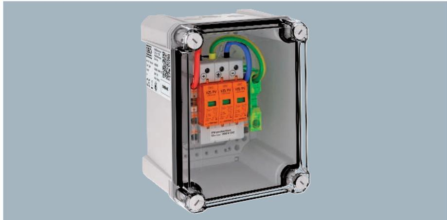
Generatoranschlusskasten Typ 1+2 für Photovoltaikanlagen zum Anschluss von 1 String. Zum DC-Schutz des Wechselrichters.
