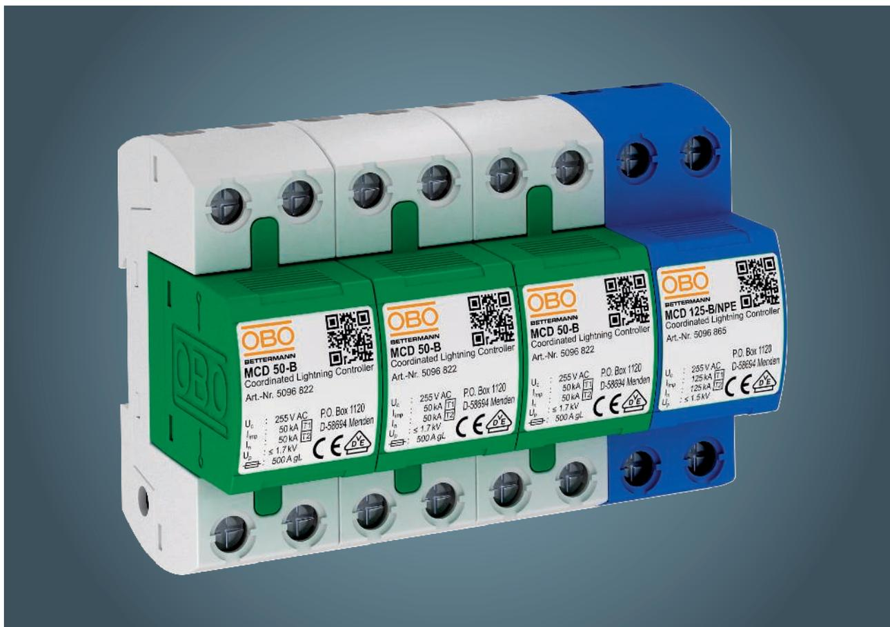
Die Kombiableiter MCD 50 entsprechen der Anforderungskategorie Typ 1+2 gemäß IEC 61643-11. Diese Geräte schützen Niederspannungsverbraucheranlagen vor Überspannungen jeder Art und sind in ein- bis vierpoliger Ausführung lieferbar. Durch die spannungsbegrenzenden Hochleistungsfunkenstrecken werden mehrere Vorteile erreicht. Eine kurze Ansprechzeit, ein tiefer Schutzpegel und eine hohe Stromableitfähigkeit bei langer Lebensdauer.
