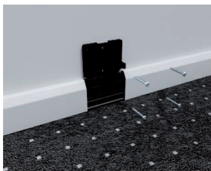
Den Geräteträger oben am Sockel ansetzen und an die Wand schrauben.
