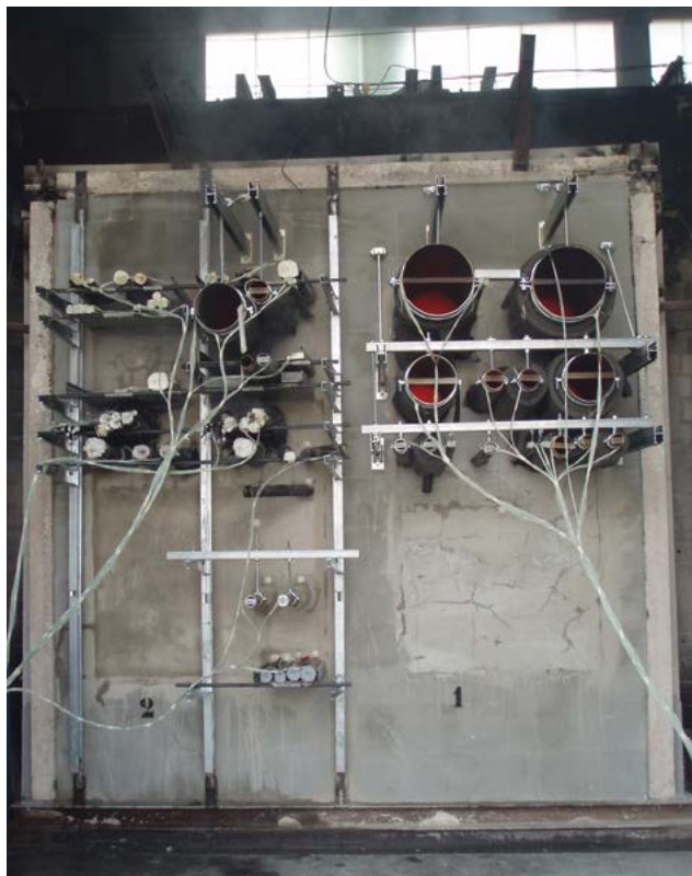
Brandprüfung an einem Mörtelschott
