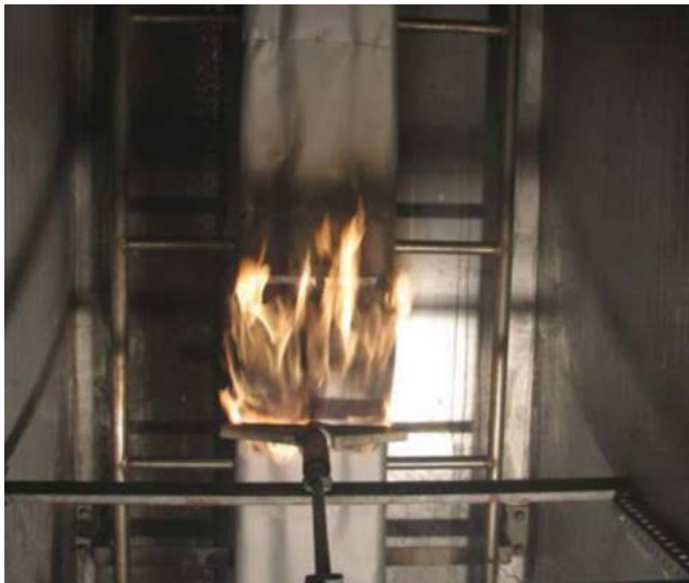
Prüfung der Kabelbandage
