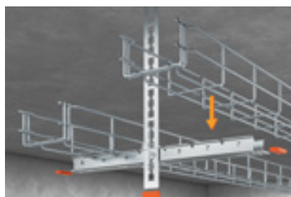
Gitterrinnen auf die Tragschiene auflegen und zusätzlich mit der Schnellbefestigung fixieren. Die Schutzkappen werden auf die Befestigungslaschen der Tragschiene und die Enden der Abhängestreifen aufgesteckt.
