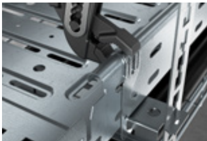
Die Schnellbefestigung kann manuell gebogen werden und/oder zusätzlich mit einer Zange angedrückt werden.
