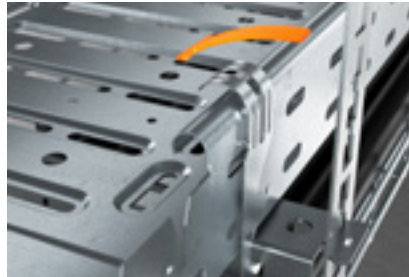
Um eine Kabelrinne auf der Tragschiene zu fixieren, werden Schnellbefestigungen in die Tragschiene eingehakt und dann um die Holmkante gebogen.
