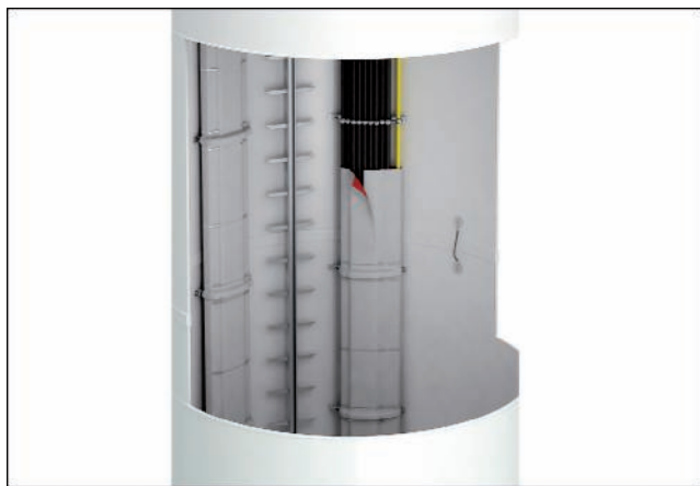
Apjuosta apsauginiu audiniu vertikali kabelių trasa vėjo jėgainės bokšte
