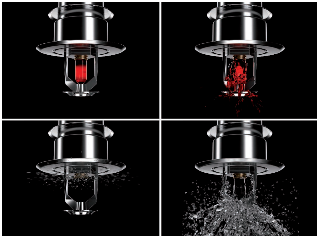
Vardinei temperatūrai ties stiklo indeliu viršijus 68 °C, suveikia purkštuvo galvutė
