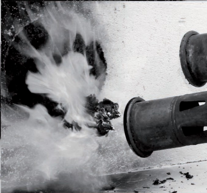
sandarinio medžiagos reakcijos savybių simuliacija
