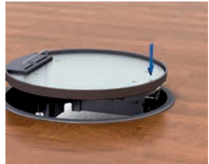
Einbau des Klappdeckels bei rundem Gerät- ein- setz GESR Deckelscharnier in Halterung einlegen. Ober- halb des Deckelscharniers auf den Deckel drü- cken, bis die Endlage erreicht ist.
