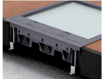
GES-2U Universalbefestigung Doppelbodenmontage, s \geq 47 mm Den Haltewinkel von der Schraube lösen und umdrehen. Schraube wieder in Haltewinkel eindrehen. In dieser Position beträgt der Klemmbereich 37 bis 75 mm.
