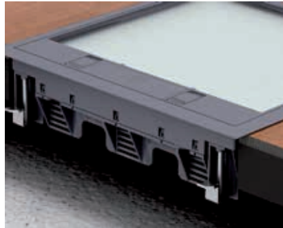
GES9-2U Universalbefestigung Doppelbodenmontage Der Spannungsbereich des Haltewinkels ist für Doppelbodenplatten mit einer Dicke bis zu 45 mm geeignet.
