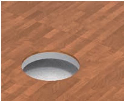
Verlegung Bodenbelag bei Kanalsystemen Bodenbelag bis an die Öffnung des Montage- deckels verlegen.
