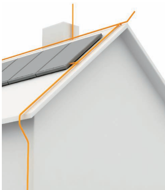
Direkter Anschluss der PV-Montagegestelle an das Blitzschutzsystem
