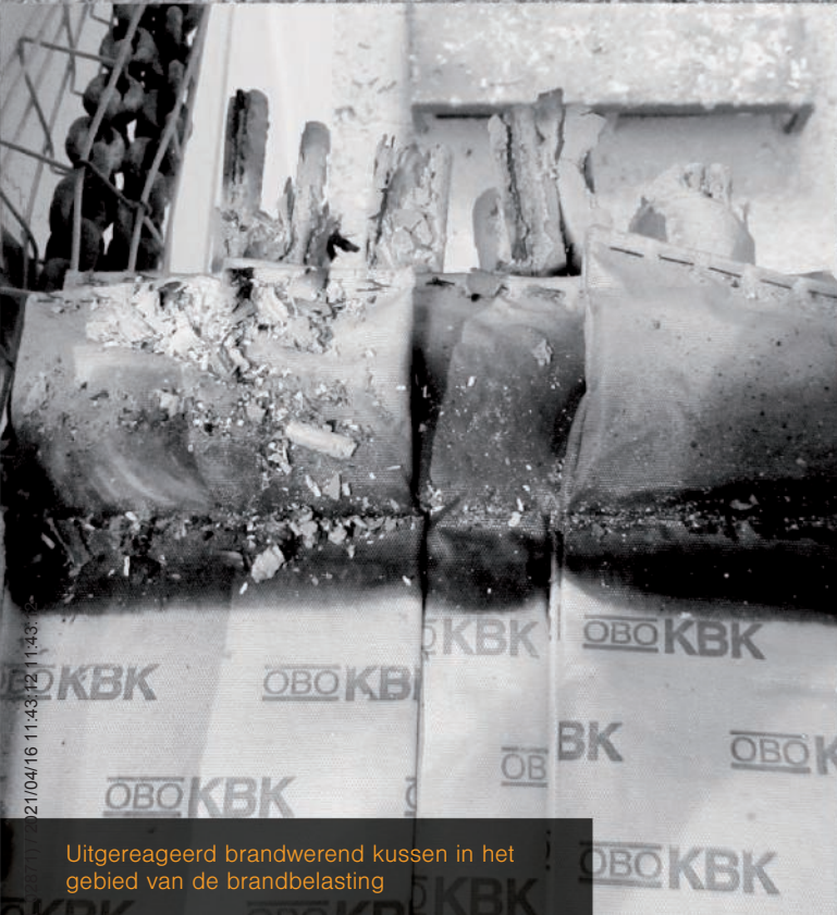
Simulatie van het reactiegedrag van brandwerend doorvoermateriaal
